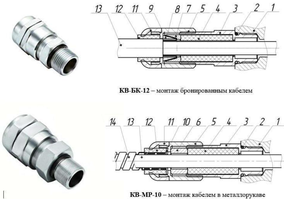
Рисунок 6 – Вводные устройства с двойным уплотнением
