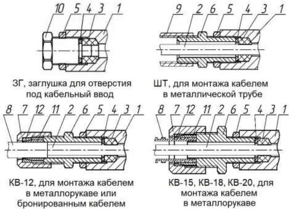
Рисунок 5 – Вводные устройства с одинарным уплотнением
